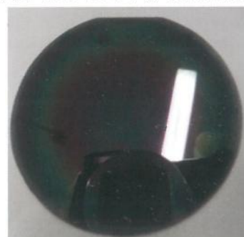
金属有机物化学气相沉积 (MOCVD) 生长的 2英寸 GaN-on-Si
