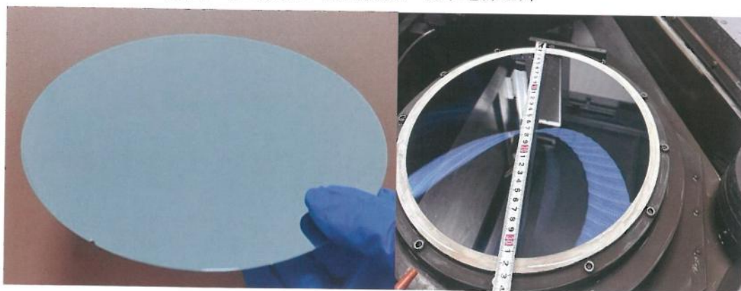
图 1, (a)8 英寸单晶铌酸锂/硅片键合减薄片, 上层铌酸锂厚度 20 微米; (b)12 英寸贴膜单晶硅减薄片, 厚度 20 微米。
