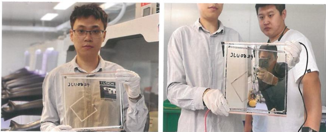
图 1. 电致反光器件: 透明状态 (左); 镜面状态 (右)
